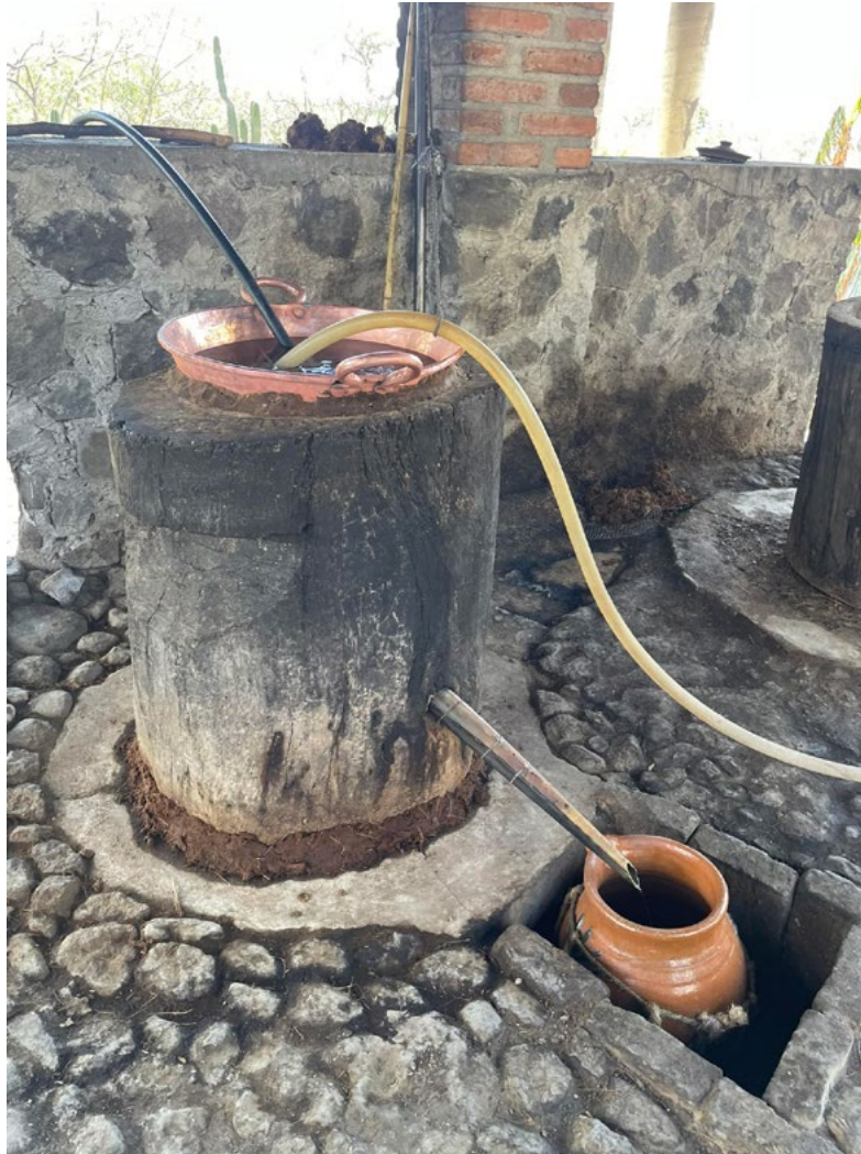
Figura 2. Destilador filipino o de influencia asiática en la taberna de Chacolo
