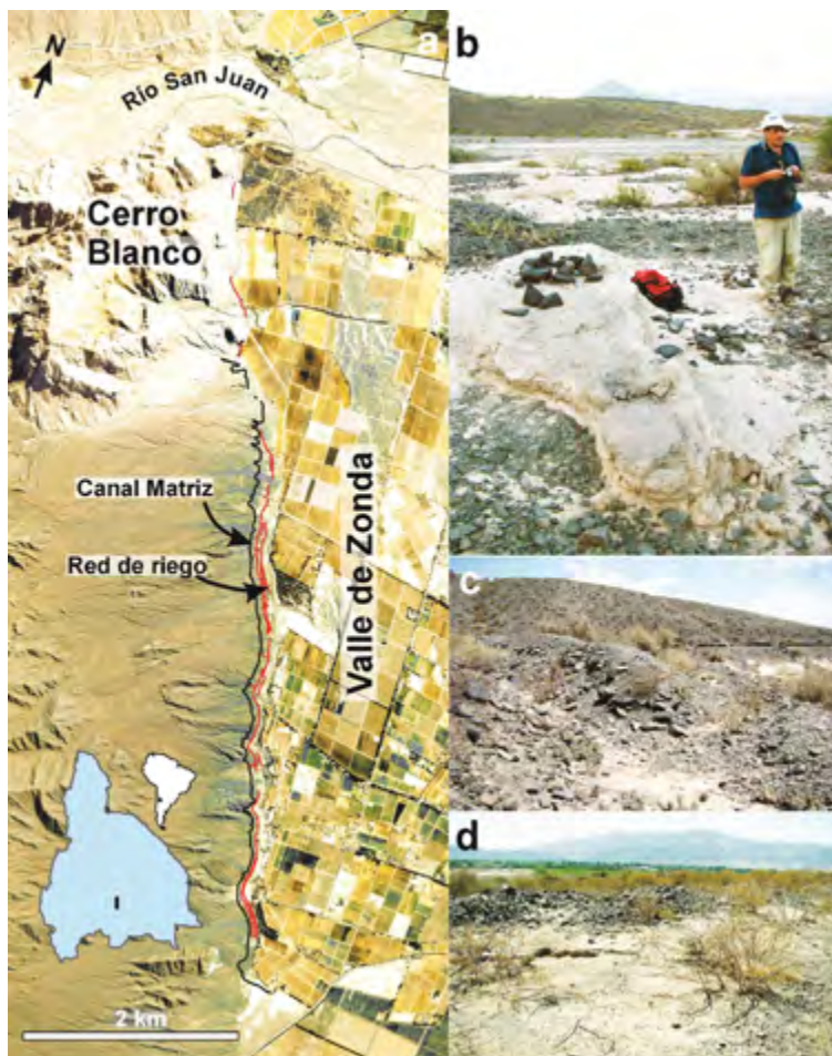
Figura 4. (a) Reconstrucción parcial del sistema de riego de Zonda (en negro el canal Matriz y en rojo la red de riego). (b) Uno de los autores (Oscar “Tito” Damiani) junto a restos de una reguera en el sector meridional del sistema. (c) Bifurcación en el canal matriz; al fondo, sector con muro de contención. d) Estanque con lugar de localización de compuerta en el sector medio Figure 4. (a) Partial reconstruction of the Zonda irrigation system (in black, the Main canal and in red the irrigation system). (b) One of the authors (Oscar “Tito” Damiani) next to the remains of a irrigation ditch in the southern sector of the system. (c) Bifurcation in the Main canal; in the background, sector with retaining wall. d) Pond with a sluiceway in the middle sector
